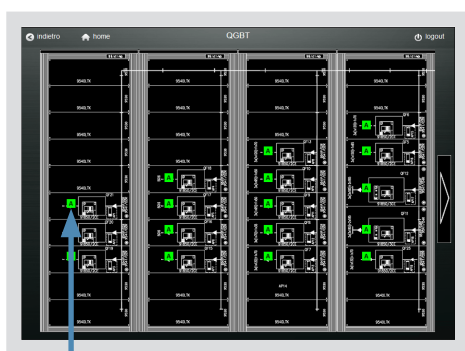
Affichage de l'état des disjoncteurs (marche, arrêt, défaut).
