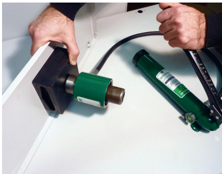
Réalisation de la découpe à l'aide d'un emporte-pièce.
